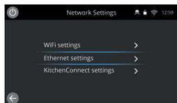
Scegliere l'opzione "Connettività" dal menu "Impostazioni". Da qui è possibile effettuare il collegamento tramite Wi-Fi o la porta Ethernet sul retro del forno.
