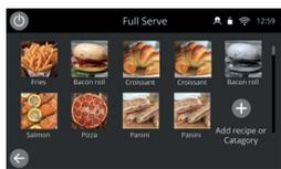
Le ricette che non sono pensate per la temperatura di preriscaldamento corrente del forno saranno inattive e visualizzate in grigio. Per impostare la temperatura di preriscaldamento di queste ricette, tenere premuta l'icona finché l'opzione di modifica/eliminazione non viene visualizzata sopra il pulsante, quindi selezionare Modifica per esaminare i parametri delle ricette. Tornare quindi alla schermata iniziale.
